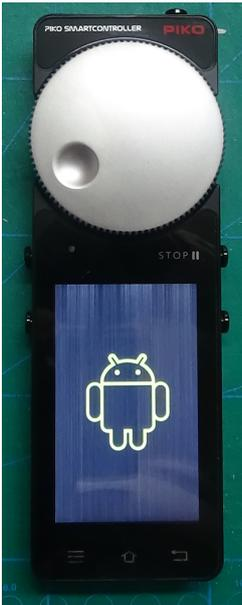
Comme on le découvre sur l'image, à la mise en route un petit robot apparaît. Ensuite rien d'autre. Impossible de l'éteindre, il faut attendre l'épuisement de la batterie. De plus au bout d'un moment elle devient brûlante.
